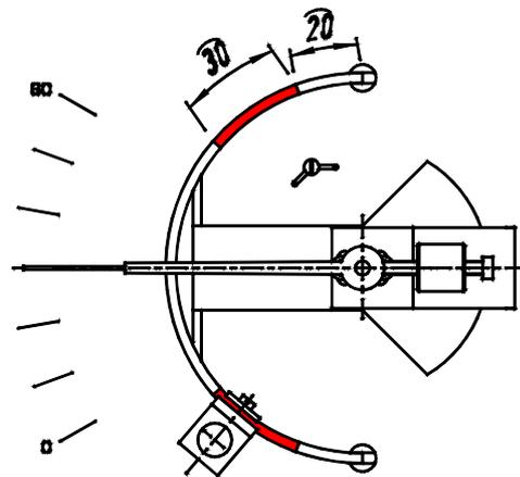
NOTA: PER UN CORRETTO FUNZIONAMENTO DELLO STRUMENTO, IL SENSORE DEVE ESSERE POSIZIONATO MANUALMENTE NEL RANGE DI FUNZIONAMENTO DELLO STESSO (VEDERE LA PARTE DELL'ARCO COLORATA NEL DISEGNO SOPRA).
