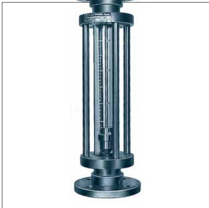
I flussimetri diretti della serie 500 hanno una robusta struttura portante (corpo), non a contatto con il fluido, con 4 colonne in acciaio. Gli attacchi al processo possono essere filettati o flangiati. Tutte le parti a contatto con il fluido da misurare vengono realizzate con vari materiali. Il tubo di misura è in vetro al borosilicato perfettamente calibrato e quindi facilmente sostituibile dal cliente mantenendo il galleggiante originale.
