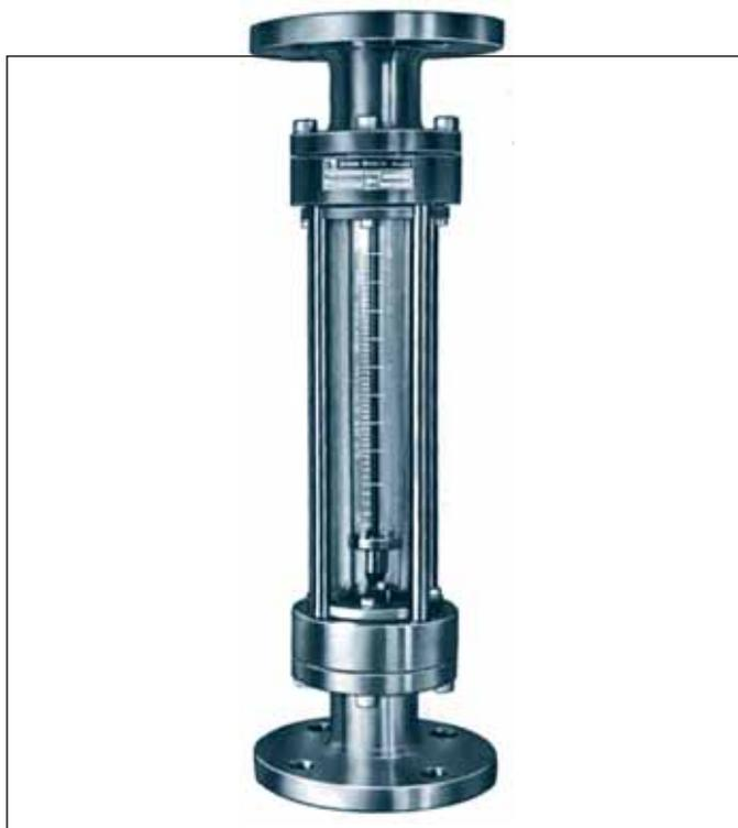
I flussimetri diretti della serie FD hanno una robusta struttura portante con 4 colonne in acciaio. Gli attacchi al processo possono essere filettati o flangiati. Il tubo di misura è in vetro al borosilicato perfettamente calibrato e quindi facilmente sostituibile dal cliente mantenendo il galleggiante originale. La tenuta è realizzata con guarnizioni e premistoppa registrabili.
